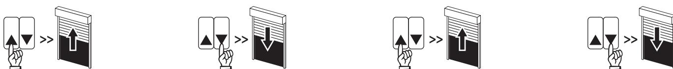
Je doporučeno provést tyto dva cykly otevření/zavření hned po namontování výrobku.
